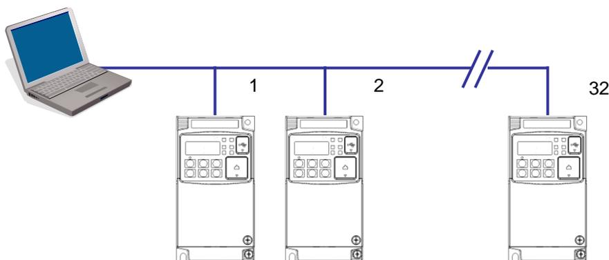
**Verbindung des Umrichters mit dem Modbus**
