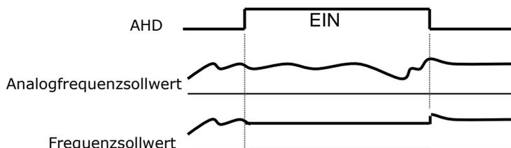
Bei AHD=EIN wird der Sollwert auch bei Netz-Aus/Netz-Ein oder Umschalten des Parametersatzes mit Digitaleingang SET gehalten.
