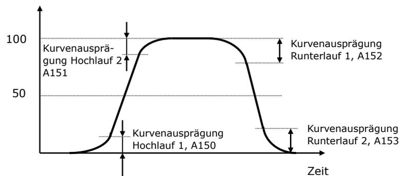
A150...A153=50%, Kurve entspricht der S-Kurve (A097/A098=03)
