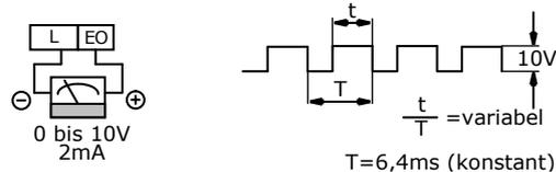
**Impulssignal für Frequenzmessgerät**
