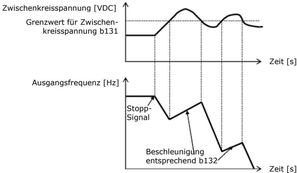
**b130=02:** Der Antrieb wird in kürzest möglicher Zeit abgebremst, wobei bei Überschreiten der unter b131 eingestellten Zwischenkreisspannung der Motor gemäß b132 beschleunigt wird. Fällt die Zwischenkreisspannung wieder unter den Wert von b131, dann wird der Antrieb wieder verzögert.
