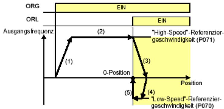
Nach Abschluss der Referenzierung wird die aktuelle Position als 0-Position festgelegt. Sollte keine Referenzierung durchgeführt werden so wird die Netz-Ein-Position als 0-Position festgelegt. Ein Start-Befehl FW bzw. RV ist zur Auslösung der Referenzierung nicht erforderlich. Nach Erreichen des Referenzschalters wird der Motor gestoppt und die Gleichstrombremsung ist aktiv. Nach Wegnahme des Signals für die Referenzierung (ORG) wird diese ausgeschaltet.
