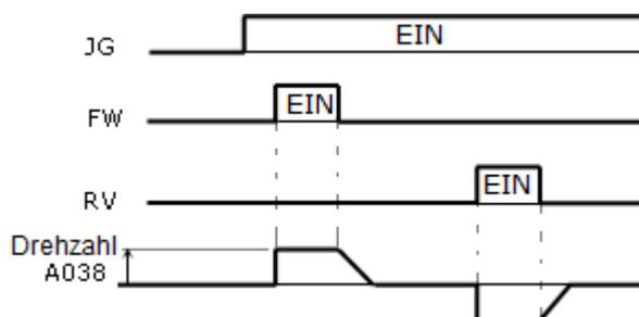
Der Tipp-Betrieb ist nicht möglich, wenn die eingestellte Tipp-Frequenz kleiner ist als die unter b082 eingegebene Startfrequenz.
