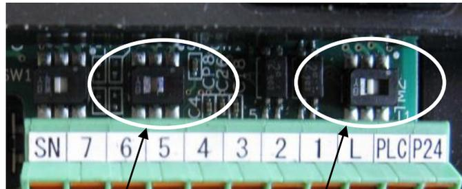
Der Schiebeschalter SFSW1 dient zur Festlegung der Digitaleingänge 3 und 4 als Sicherheitseingänge GS1 und GS2. Er befindet sich über der Steuerklemme 5.
