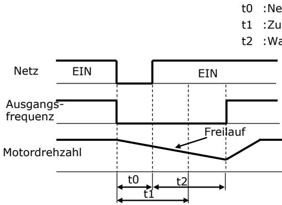
**Die Netzausfallzeit ist kürzer als die unter b002 programmierte Zeit.** Nach Ablauf von t2, Synchronisierung auf die Motordrehzahl und Hochlauf auf die Motordrehzahl
