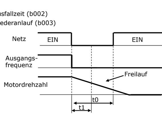
**Die Netzausfallzeit ist länger als die unter b002 programmierte Zeit.** Der Frequenzumrichter geht auf Störung
