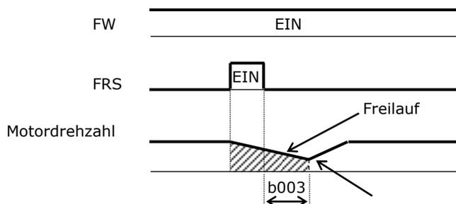
**b088=02:** Synchronisieren auf die Motordrehzahl nach Ablauf der unter Funktion b003 eingegebenen Wartezeit durch aktives Erfassen der Motordrehzahl. Da dieses Verfahren unabhängig von der Motorinduktionsspannung arbeitet kann es auch dann angewendet werden wenn der Motor sehr lange spannungsfrei gewesen ist.
