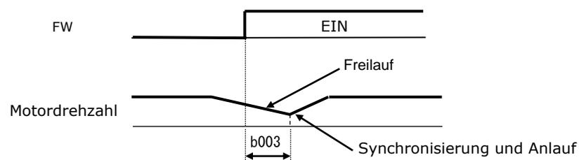
**b088=02:** Synchronisieren auf die Motordrehzahl nach Ablauf der unter Funktion b003 programmierten Wartezeit durch aktives Erfassen der Motordrehzahl. Da dieses Verfahren unabhängig von der Motorinduktionsspannung arbeitet kann es auch dann angewendet werden wenn der Motor sehr lange spannungsfrei gewesen ist und keine messbare Induktionsspannung generiert.
