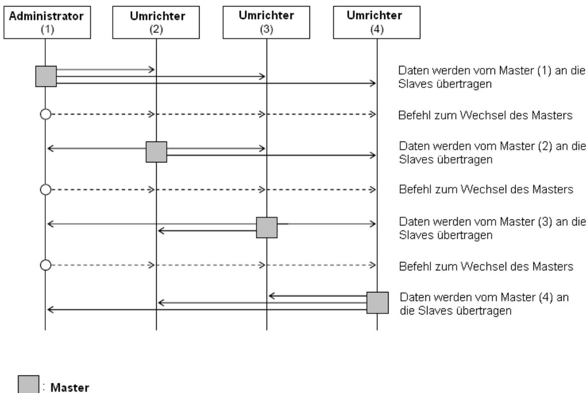
Der Befehl zum Wechsel des Masters erfolgt nachdem die Daten vom Master an die Slaves geschickt wurden und nach Ablauf des Stummintervalls sowie der Wartezeit unter C078.
