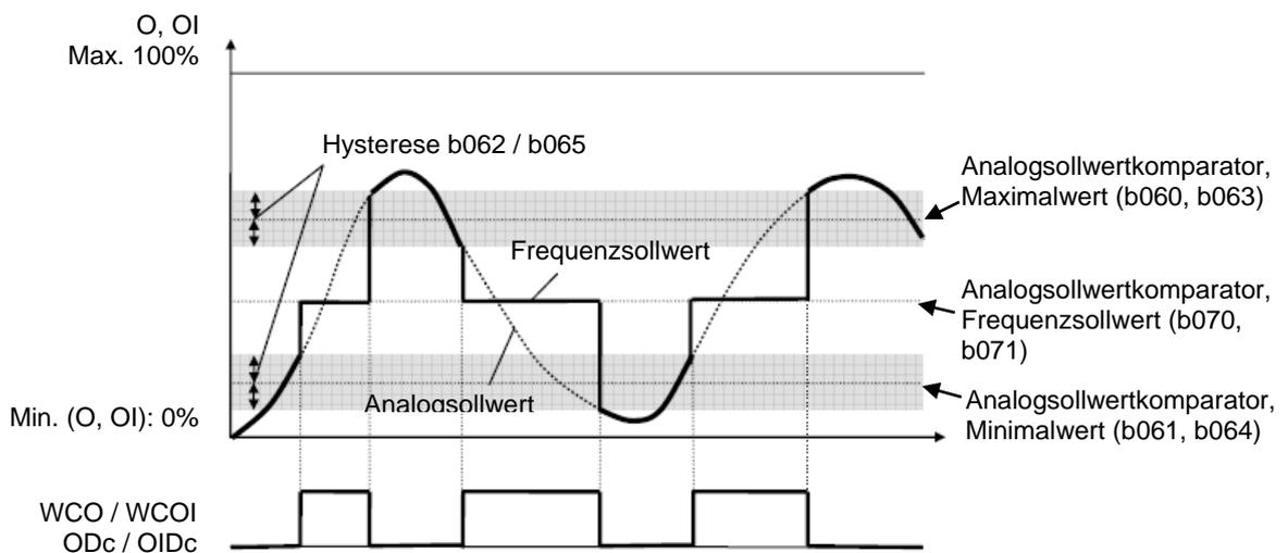
**Beispiel 1: Bei Analogsollwerten <0,5V an Analogeingang O soll Ausgang ODc gesetzt werden. In diesem Fall soll der Umrichter mit 40Hz fahren. Voraussetzung: A004=50Hz**
