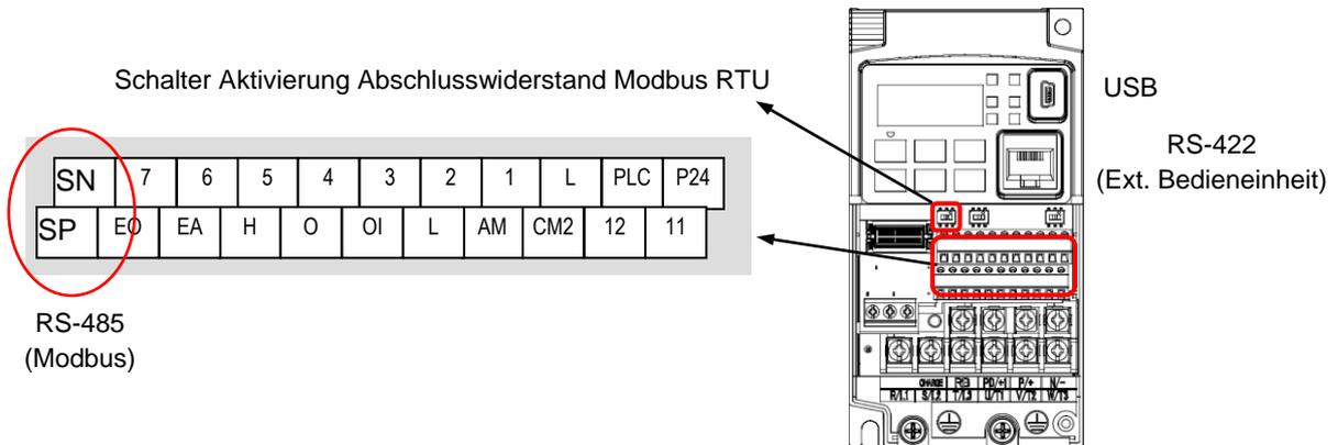
Zur Vermeidung elektrischer Reflektionen bzw. Übertragungsfehlern sollte an beiden Leitungsenden des verwendeten Kommunikationskabels ein Abschlusswiderstand verwendet werden. Mit dem entsprechenden Schiebeschalter kann am Umrichter der integrierte Abschlusswiderstand von 200Ω aktiviert werden. Die Abschlusswiderstände sollten der charakteristischen Impedanz des Kommunikationskabels entsprechen. Die Verdrahtung ist in der Zeichnung unten dargestellt.
