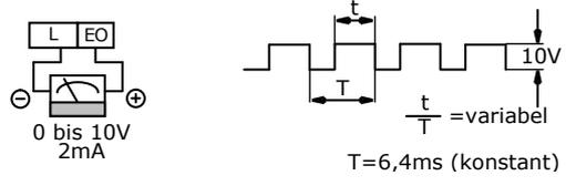
**Imulssignal für Frequenzmessgerät**
