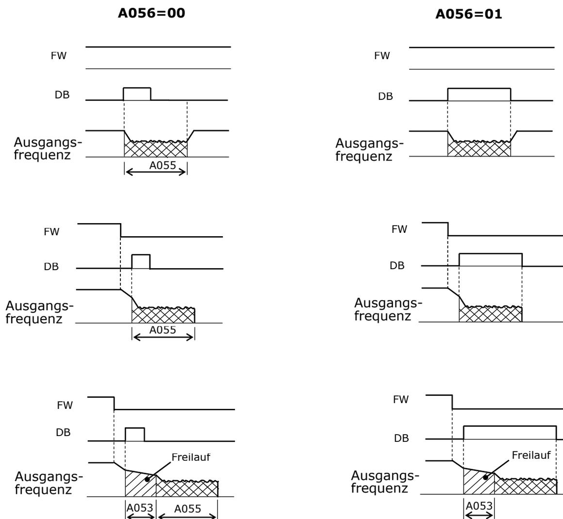
Die Gleichstrombremse kann auch beim Starten des Motors mit den Parametern A057 und A058 aktiviert werden
