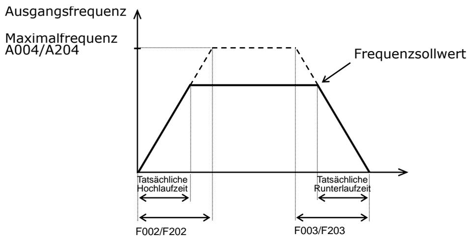
b091=01: bei Stopp wird nicht entsprechend der Runterlaufzeit abgebremst sondern die Endstufen werden abgeschaltet und der Antrieb läuft unkontrolliert aus.
