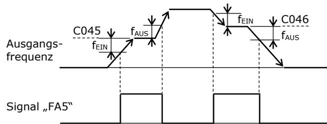
$f_{EIN}$ : 1% der Maximalfrequenz (A004),  $f_{AUS}$ : 2% der Maximalfrequenz (A004)
