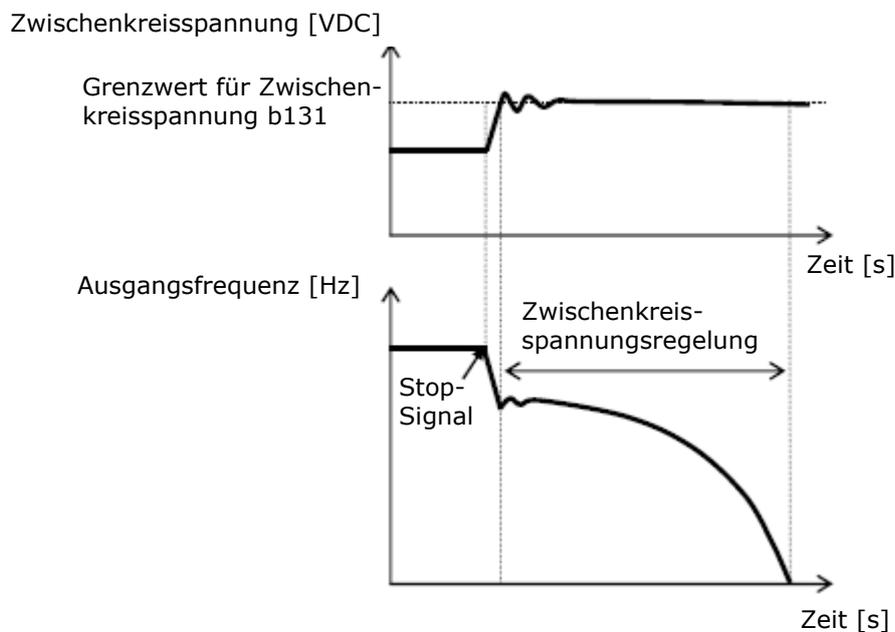
**b130=02:** Der Antrieb wird in kürzest möglicher Zeit abgebremst wobei bei Überschreiten der unter b131 eingestellten Zwischenkreisspannung der Motor gemäß b132 beschleunigt wird. Fällt die Zwischenkreisspannung wieder unter den Wert von b131, dann wird der Antrieb wieder verzögert.
