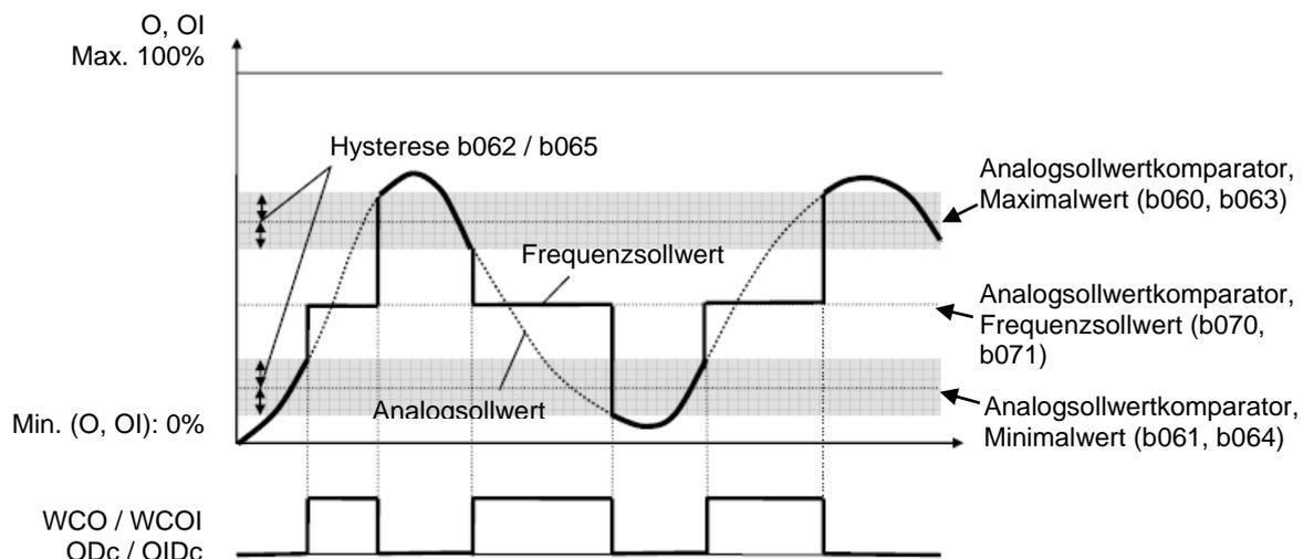
**Beispiel 1: Bei Anlagensollwerten <0,5V an Analogeingang O soll Ausgang ODc gesetzt werden. In diesem Fall soll der Umrichter mit 40Hz fahren. Voraussetzung: A004=50Hz b060=5% (2,5Hz), b061=0%, b062=0%, b070=80% (40Hz), C021=27 (Digitalausgang 11 = ODc)**
