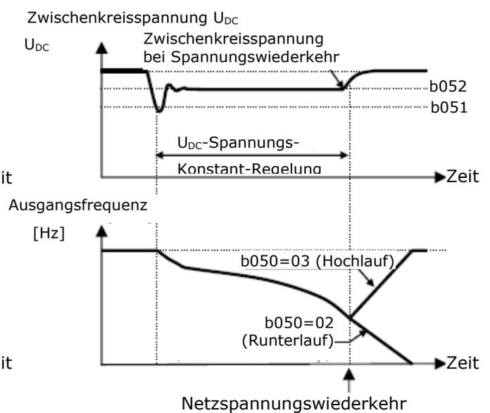
Der geführte Runterlauf kann – wenn er einmal eingeleitet wurde – nicht durch einen Start-Befehl unterbrochen werden. Zum erneuten Start, warten Sie bis der Antrieb gestoppt ist, geben Sie danach ein Stopp-Signal und starten dann den Antrieb erneut.
