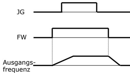
Erfolgt das Signal für den Tipp-Betrieb nachdem ein Startbefehl erfolgte, so bremst der Frequenzumrichter bei den Eingaben 03, 04 und 05 mit der eingestellten Zeitrampe auf 0Hz um dann ohne Rampe auf die Tippfrequenz zu fahren.
