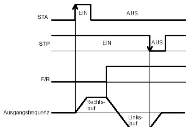
In der Grundeinstellung (Schaltlogik des Digitaleingangs „Schließer“ C011...C017=00) ist die Funktion STP wie im Bild dargestellt ein Öffner. Durch Invertierung der Schaltlogik des Digitaleingangs auf Schließer (C011...C017=01) kann STP auch als Schließer verwendet werden.
