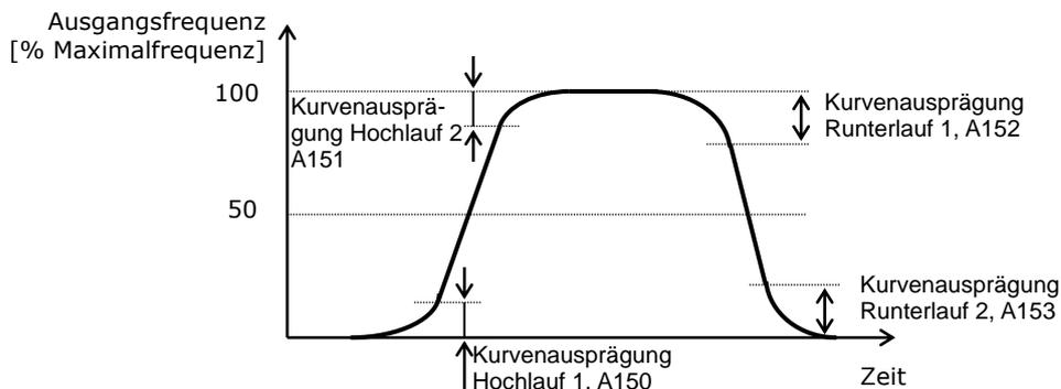
A150...A153=50%, Kurve entspricht der S-Kurve (A097/A098=03)
