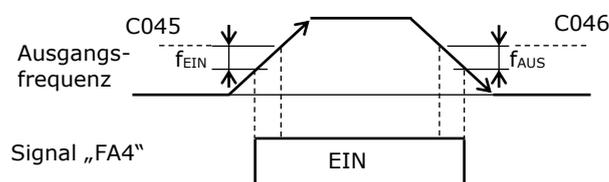
$f_{\text{EIN}}$ : 1% der Maximalfrequenz (A004),  $f_{\text{AUS}}$ : 2% der Maximalfrequenz (A004)
