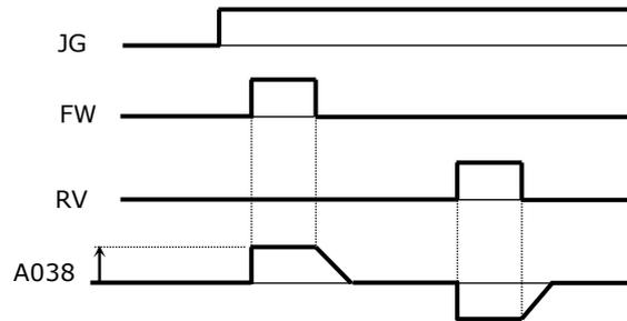
Der Tipp-Betrieb ist nicht möglich, wenn die eingestellte Tipp-Frequenz kleiner ist als die unter b082 eingegebene Startfrequenz.
