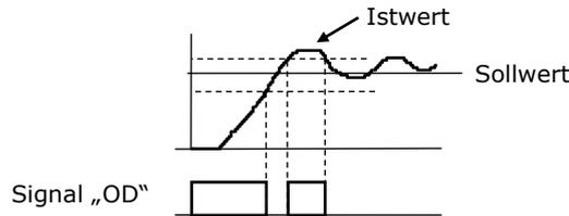
**FBV 31 PID- Istwertüberwachung C021...C026=31**
