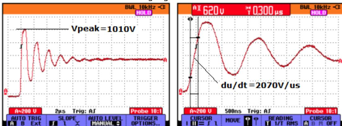
Mit Motordrossel  $0,137\text{ mH}$  am Umrichter Ausgang
