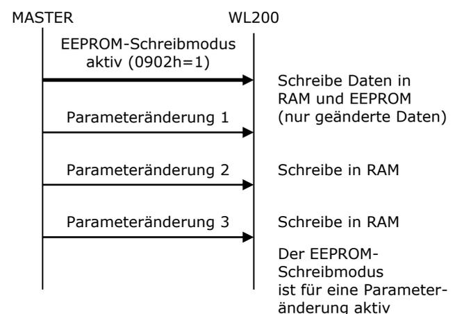
**11.1 Parameter zur seriellen Kommunikation Modbus RTU**
