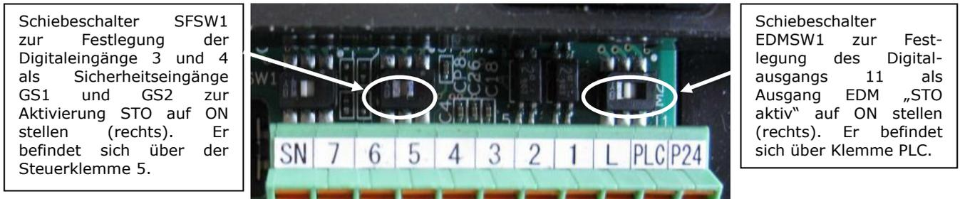
Schiebeschalter SFSW1 zur Festlegung der Digitaleingänge 3 und 4 als Sicherheitseingänge GS1 und GS2 zur Aktivierung STO auf ON stellen (rechts). Er befindet sich über der Steuerklemme 5.
