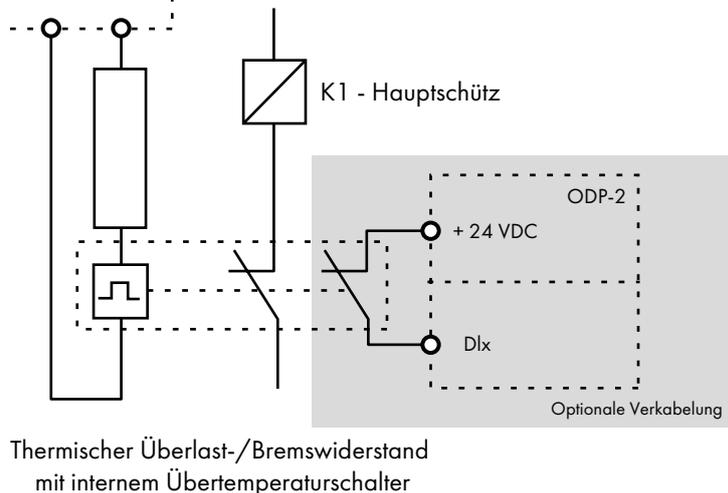
**Der Spannungspegel an diesen Klemmen kann 800 VDC überschreiten.**
