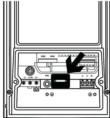
Die Aktivierung des Brems transistors erfolgt über P1-05 (siehe Abschnitt 6.2. Parametergruppe 1 – Grundparameter auf Seite 43 for further information).
