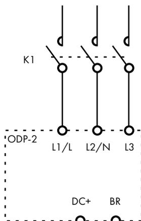
**Es wird dringend empfohlen, den Umrichter mit einem Hauptschütz auszustatten und einen zusätzlichen thermischen Überlastschutz für den Bremswiderstand vorzusehen und zu verwenden.**
