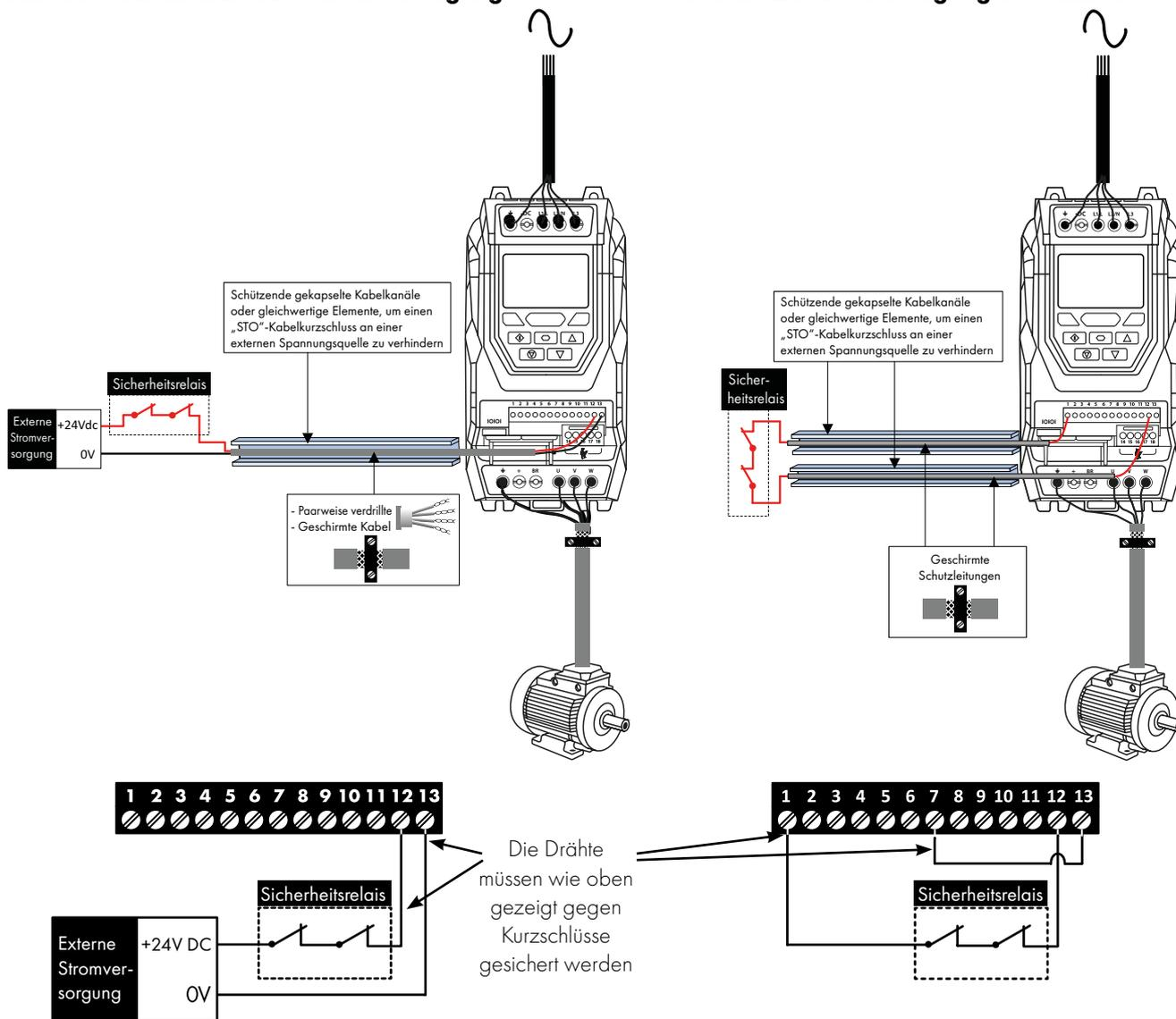
**HINWEIS** Die maximale Kabellänge zwischen Spannungsquelle und Umrichteranschlüssen darf 25 Meter nicht übersteigen.
